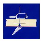
abgehängte, geschlossene Decke aus großformatigen GFK-Paneelen für Bereiche mit hoher Luftfeuchtigkeit oder aggressiver Athmosphäre.
