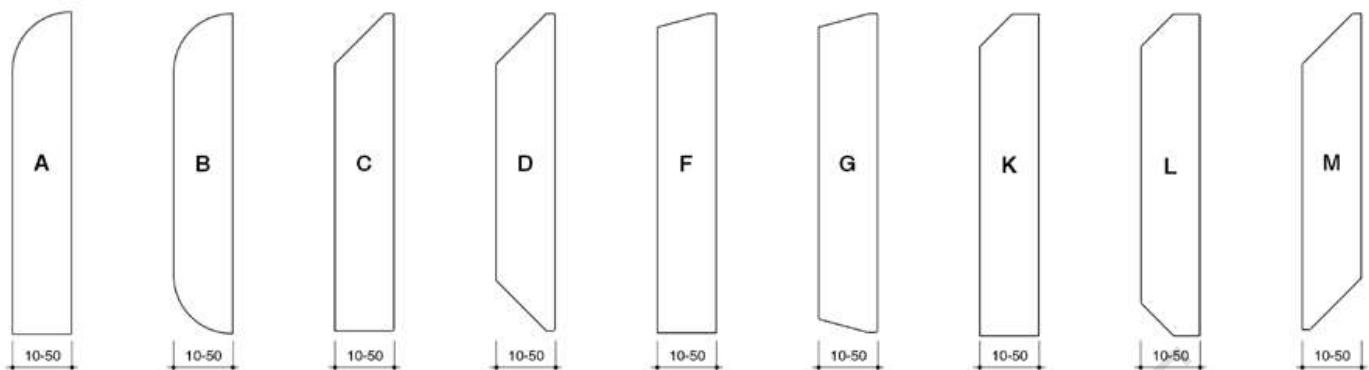
Die Kantenprofilierung kann individuell für jede Kante einzeln - Ober- und Unterkante sowie Endabschlüsse - gewählt werden. Hierzu stehen Ihnen diverse Standardprofile zur Verfügung. Für eine individuelle Profilierung bitte anfragen.
